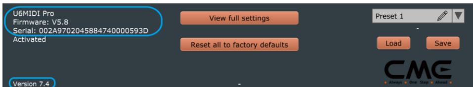
如果軟體發現 CME 伺服器上有比已連接設備的內置韌體更高的版本，軟體將會通過彈窗提示需要升級。請點擊 [Yes, upgrade] 按鈕，軟體將自動下載最新韌體程式並安裝到已連接的設備中。升級完成後，軟體會提示用戶通過重新拔插設備來啟用最新韌體。
