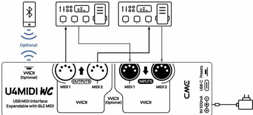
1. Conecte un adaptador de corriente de 9 V a la toma de corriente de CC para alimentar el U4MIDI WC
