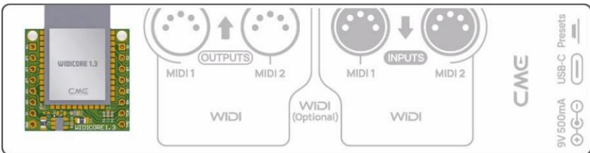
5. Vuelva a colocar la placa base del U4MIDI WC en la carcasa y fíjela con tornillos.
