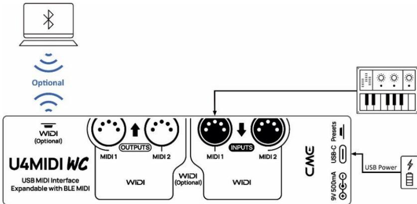
1. Encienda el U4MIDI WC con WIDI Core instalado y confirme que el LED azul oscuro parpadea lentamente.
