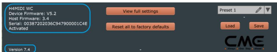
Si le logiciel détecte que le serveur CME dispose d'une version supérieure au micrologiciel intégré de l'appareil connecté, le logiciel vous demandera de mettre à niveau via une fenêtre contextuelle. Veuillez cliquer sur le bouton « Oui, mettre à niveau », et le logiciel téléchargera automatiquement le dernier micrologiciel et l'installera sur l'appareil connecté. Une fois la mise à niveau terminée, le logiciel invite l'utilisateur à activer le dernier micrologiciel en rebranchant l'appareil.
